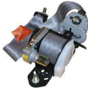
Nötralize edilmiş gergi sistemli emniyet kemeri
